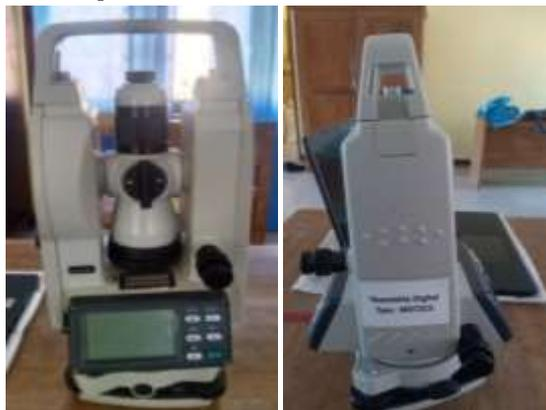
**Gambar 1.** Theodolite Digital Tipe MDT2CS Untuk Pengukuran dan Pemetaan Tanah Secara Digital.
