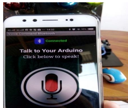
Gambar 6. Koneksi Android dengan Bluetooth HC 06
