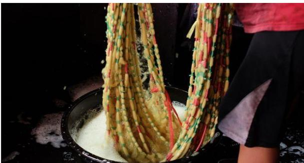
Gambar 3 Proses Pencelupan Warna
