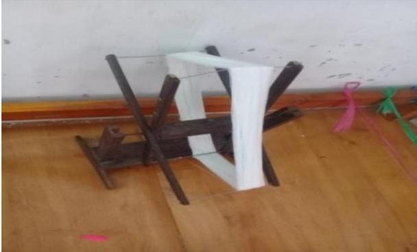
Gambar 1 Proses Penggulung Benang pada Alat Peleting
